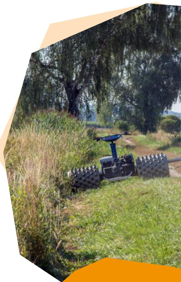
Ein handgeführtes Doppelmesser schont Insekten bei der Mahd. Mit speziellen Geräten lässt sich auch an Böschungen und Hängen gut arbeiten. © Wolfgang Willner
